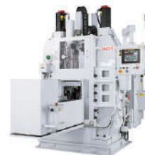
精密転造盤 (EVの部品などを加工)
