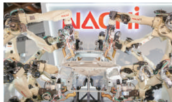
スポット溶接ロボット (EVのボディーなどを加工)
