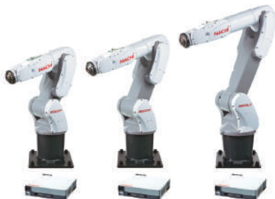
高速・高精度な小型ロボット「MZ Fシリーズ」/ 超コンパクト制御装置「CFDq」
