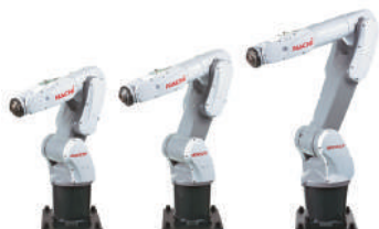
高速・高精度な小型ロボット「MZ Fシリーズ」 (幅広い業種の自動化に貢献)
