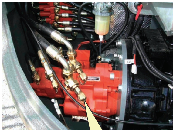
ピストンポンプ ミニショベルのエンジンルームでも、NACHIの油圧が活躍。
