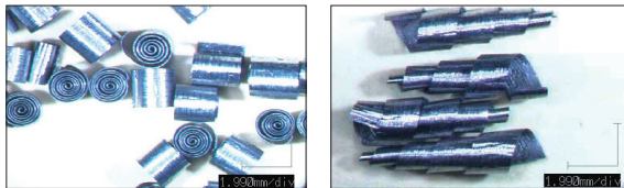
図9. ねじれ刃溝ブローチの切りくず
