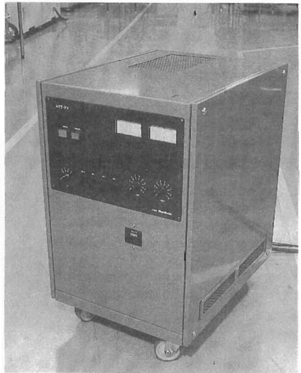
図6. 放電ツルージング専用放電電源(400×500×700mm)
