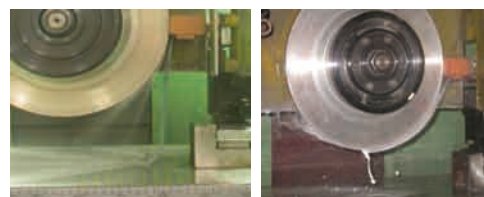
(a) 研削液飛散 (b) 導液シートの適用状態
