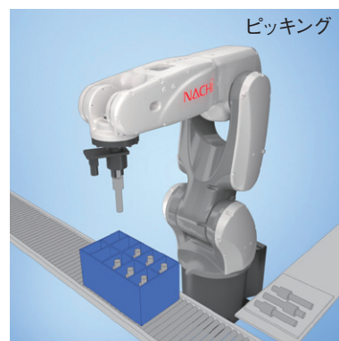
ピッキング コンテナで供給されるワークを取り出し、 ラインに供給(視覚センサ仕様)
