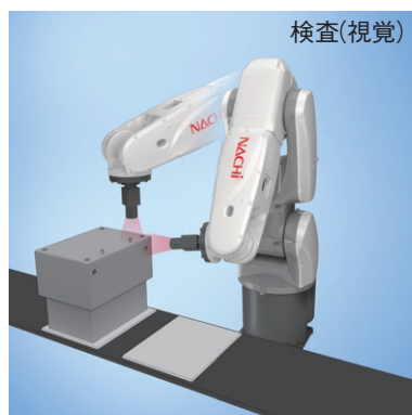
検査(視覚) カメラを搭載、ワークの穴位置を検査 (視覚仕様)
