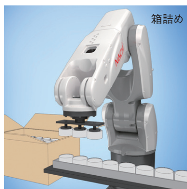
箱詰め コンベアより流れてきたワークを 出荷梱包用の段ボール箱へ箱詰め (パレタイズ機能)
