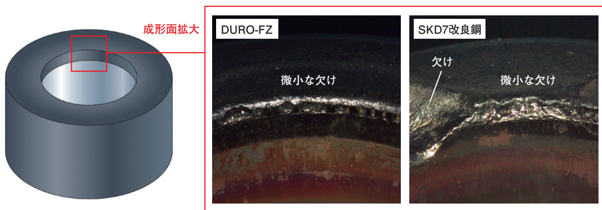
図11 30,000ショット使用後の熱間ダイ成形面外観
