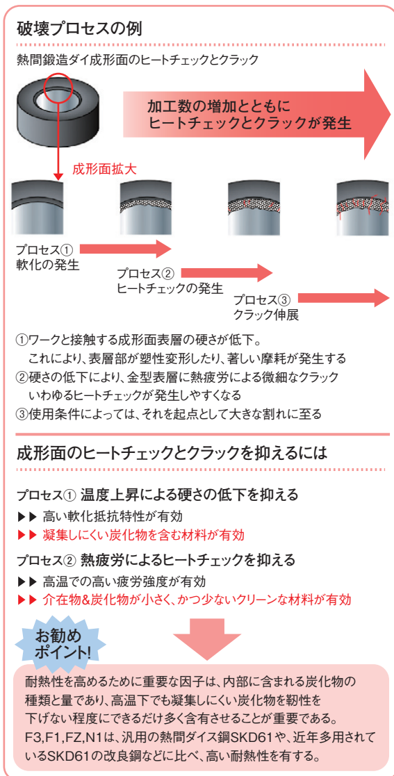
図4 熱間鍛造ダイ破壊プロセスの例
