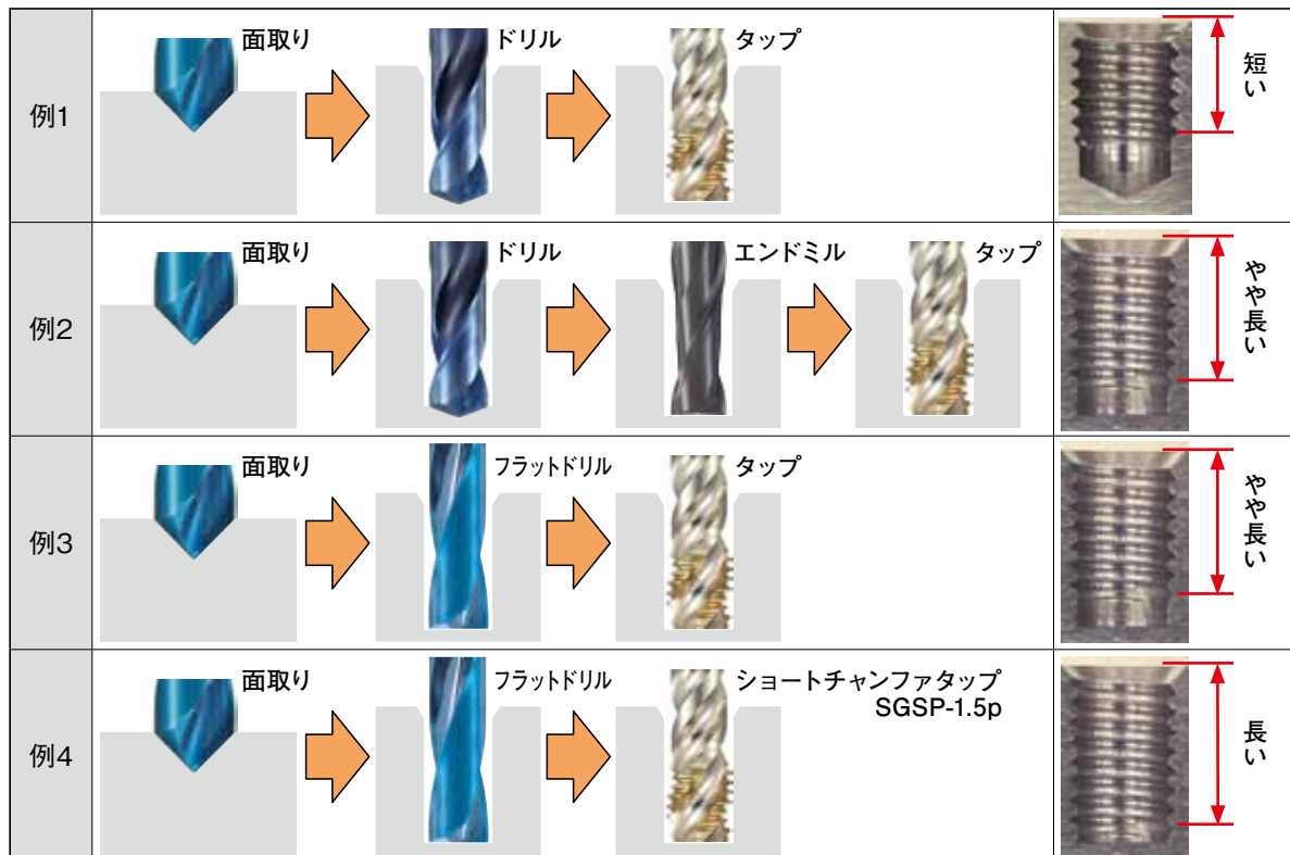
図8 ねじ有効長と工程短縮事例
