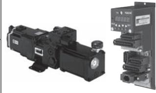
ACサーボモータで油圧ポンプの回転速度と方向を制御します。機械サイクルに合わせた流量と圧力を発生させ、アイドルタイムには止
