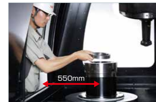
ワーク脱着、段替えが容易 ジグへの距離が短く、寄り付き性が良好
