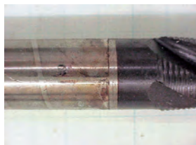
ストレートシャンクの応力腐食 シャンク部の折損(コレット内)
